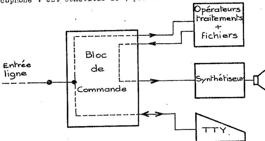
Le bloc de commande constitue la partie qui a pour rôle la gestion des différents modules. C'est l'unité centrale d'un mini-calculateur (ORDOPROCESSEUR), dont la microprogrammation a été réalisée en collaboration avec TITN.
