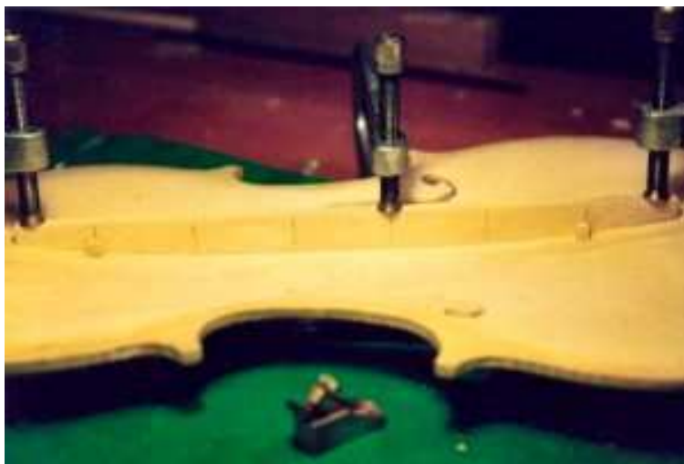
FIG. 3.4 – Exemple de forçage de la barre du violon, d'après [38]
