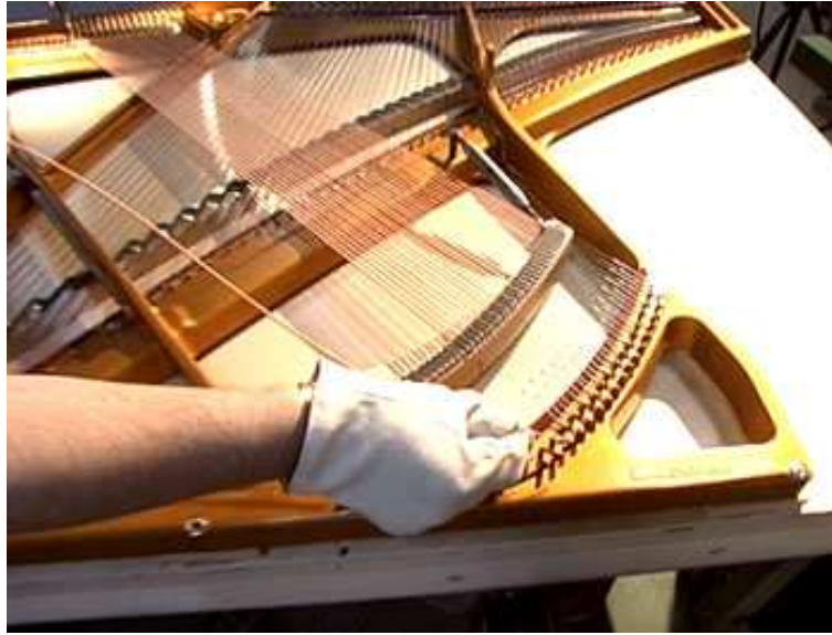
FIG. 3.2 – Exemple de réglage de la charge du piano à l'aide d'une plate-forme, d'après [77]
