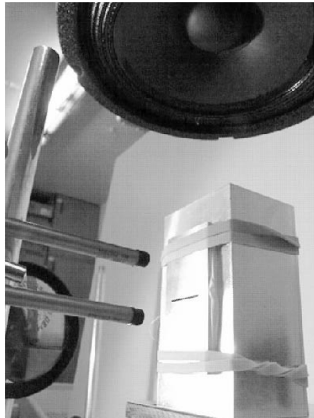
FIG. E.2 – Photo du montage expérimental utilisé pour mesurer le comportement d'un jet excité par un haut-parleur. Sont visibles le pied et la pièce amovible qui fait office de canal, le haut-parleur permettant la simulation d'un champ acoustique dont on maîtrise la fréquence et le doublet de microphone utilisé pour mesurer la vitesse acoustique.
