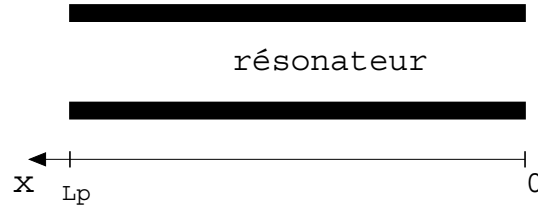
FIG. 1.1 – Définition de l’axe des x utilisé pour la modélisation du résonateur, L_p longueur physique du résonateur.
