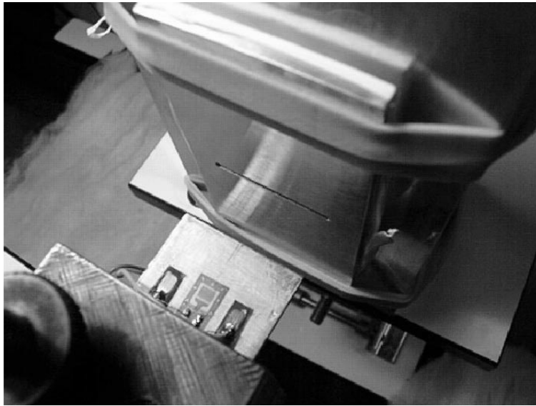
FIG. 6.3 – Configuration de son de biseau : le jet issu d'un volume fixe interagit avec un biseau placé en face. Celui-ci est libre d'un côté, encastré dans une mâchoire de l'autre. Lorsque le système est en auto-oscillation, le mouvement du jet de part-et-d'autre du biseau exerce une force F(p_f) sur celui-ci. Cela provoque une déformation qui est mesurée par les jauges de contraintes ( Haut : représentation schématique vue de profil, Bas : photo du montage expérimental vu de dessus).
