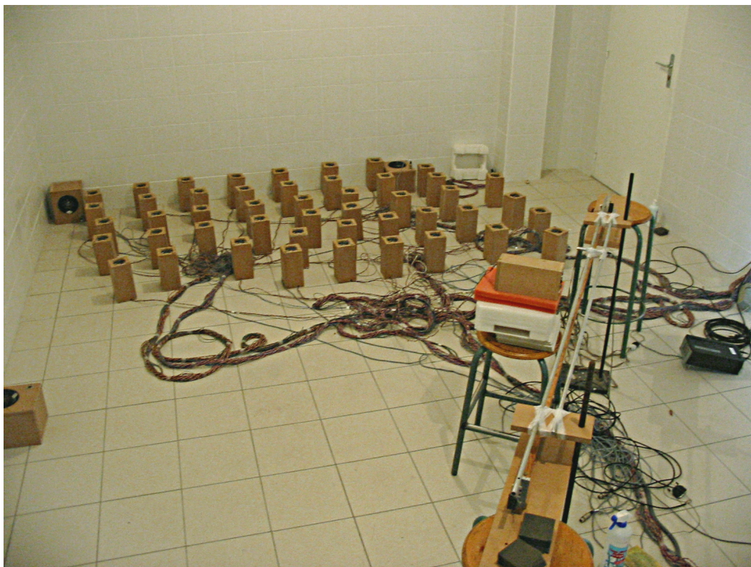
FIG. 2.1: Dispositif expérimental de focalisation par retournement temporel à 42 haut-parleurs dans la chambre réverbérante
