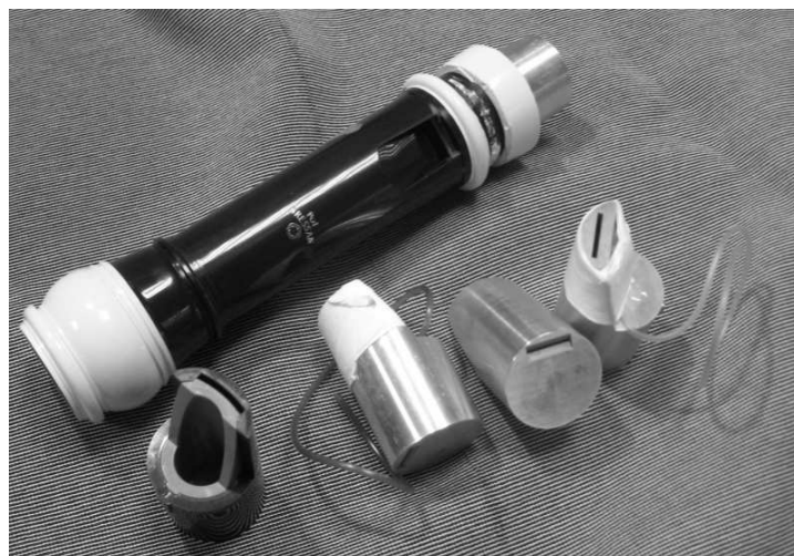
FIG. 6.5: Photographie de la pièce d'embouchure de la flûte à bec modifiée et de quelques becs usinés. La pièce d'origine est disposée en bas à gauche de l'image
