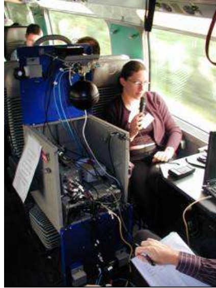
Figure 11 - Système de mesures physiques lors du trajet en salle haute du Duplex (OCTAVE)
