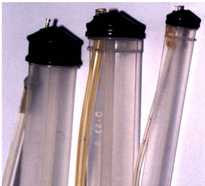
FIG. 2.4 – Trois exemples du dispositif retenu pour alimenter en pression le corps de la seringue : soit des tubes de plastique, soit un fragment d'aiguille.
