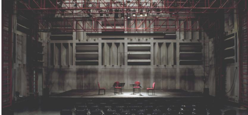
FIGURE 1.1 – Vue de l'Espace de Projection de l'IRCAM, Paris, France. Les murs sont faits de panneaux rotatifs constitués de trois faces. L'une est plate et rigide favorisant les réflexions spéculaires, une autre présente une surface irrégulière adaptée à la diffusion du son, la dernière est perforée et absorbante. Le temps de réverbération annoncé peut varier entre 0,4 s et 4 s. Inauguration : 1978 Acousticien : Peutz.
