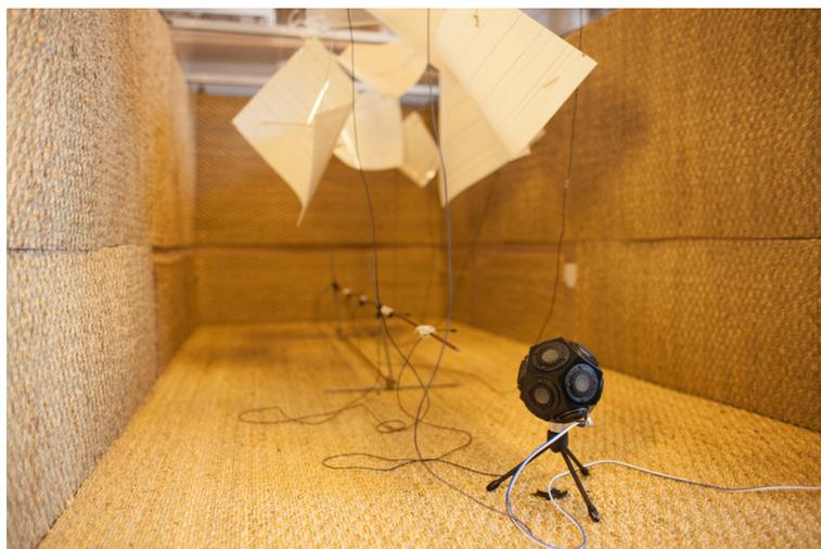
FIGURE 3.8 – Photographie de la salle principale couverte de jonc de mer, avec la source à 12 tweeters et un alignement de microphones.
